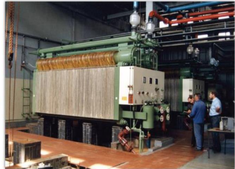
Aswan Electrolyser (KIMA) 165MW - 37000 m 3 H 2 /h
